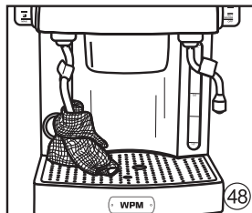
用濕布清潔蒸汽管及噴嘴，再開蒸汽10秒
