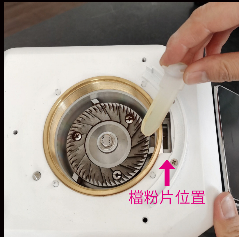
把檔粉片拔出並清理乾淨，同時把出粉通道裡面的粉清理乾淨並安裝回去
