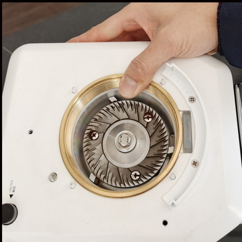
清理下刀盤以及下刀盤的螺紋
