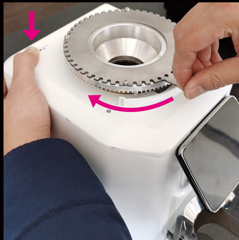
將上下刀盤螺紋銜接好並按住鎖定鍵，同時拿住手柄並按順時針方向旋轉直至擰緊，然後再往逆時針方向旋轉至6點的方向即可
